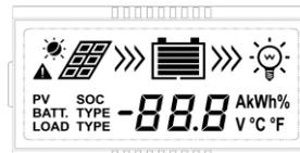
备注: 水平视线和液晶屏的角度在 90° 范围内才可以清晰的看到液晶屏的显示内容。如果角度超过 90°, 液晶屏的显示内容无法看清。
