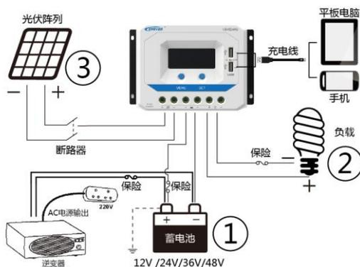
接线顺序: ①连接蓄电池 > ②连接负载 > ③连接光伏阵列 > ④控制器上电
