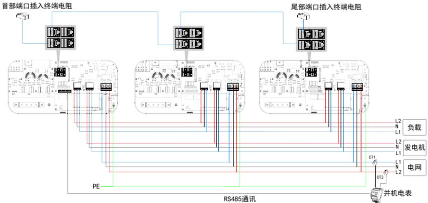
注: 需要使用并网专用电表(正泰 DTSU666 裂相导轨电表, 配备 2 个 CT)。详细并网操作说明请前往 <https://www.epever.com.cn/download.html> 获取《EHD 系列并网储能逆变器并网使用手册》。
