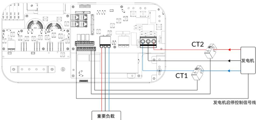
该模式下发电机代替电网工作，将发电机接到 Grid 接口，可旁路给重要负载供电、给电池充电，但是储能系统不能馈电给发电机，因此模拟电网模式主要适用于自发自用和削峰模式。
