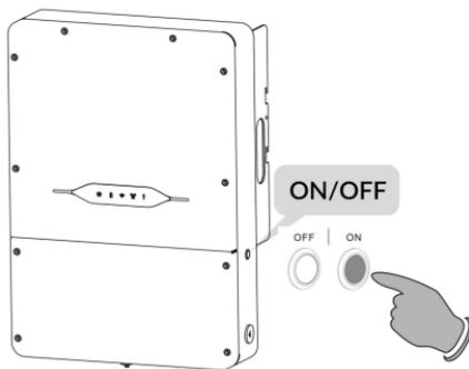
ON/OFF 开关机按钮集成在产品机箱右侧，功能是按下按钮后会触发储能逆变器关机，只有电网旁路给负载供电，电池和 PV 停止工作。其中开关凹陷进去是关机状态，弹起是初始状态。
