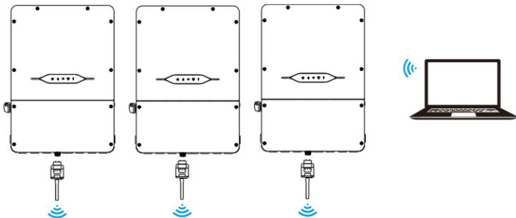
逆变器的运行信息（发电量、报警、运行状态）可通过 WiFi/GPRS 等通信模块上传到服务器。用户可根据需要选择使用 WEB 或 APP 进行监控查看。用户需要注册一个账户，并将设备与 WiFi/GPRS 等通信模块的序列号进行绑定。WiFi/GPRS 的序列号贴在包装盒和 WiFi/GPRS 模块上。
