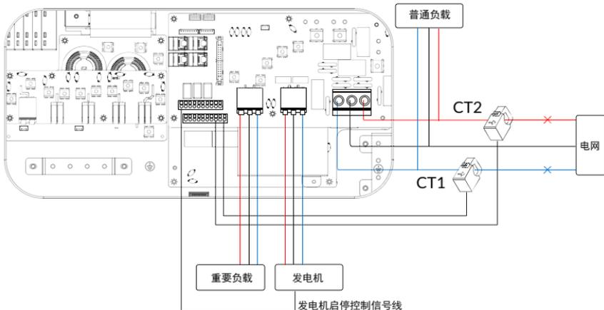
该模式是当电网出现异常、电池容量下降到放电下限值时，开启油机给电池补电并给重要负载供电。
