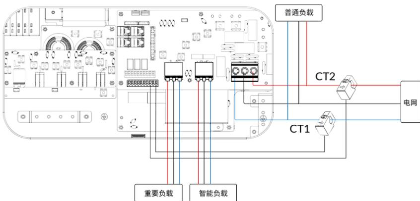
该模式主要是针对智能负载的应用，智能负载接在 GEN 接口。智能负载主要是梯次供电，先保证重要负载供电，而后根据系统的储备能量和功率分配确定是否给智能负载供电。
