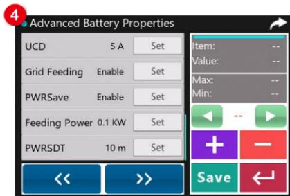
4. 点击
