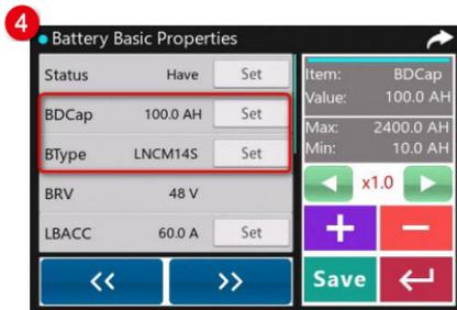
4. 根据实际使用的电池，设置“BDCap（蓄电池总的容量）和 BType（电池类型）”。设置完成后，点击 **Save** 下发新参数值。
