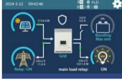
$P_{PV} > P_{LOAD} \quad \Bigg  \quad P_{PV} \leq P_{LOAD}$
