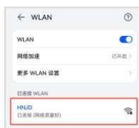
**第7步：**进入手机“WLAN”界面，将手机连接的WiFi热点网络，切换到有上网功能的WiFi网络或4G网络，从而连接到服务器获取到数据。点击 ← 返回APP。点击“完成”进入设备列表。
