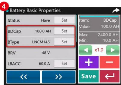
4. 根据实际使用的电池，设置“BDCap (蓄电池总的容量)、BType (电池类型)”。设置完成后，点击
