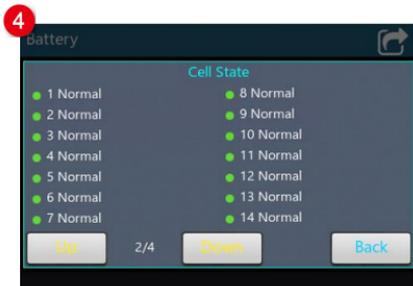
4. 点击 **Down** 按钮，显示第二页“Cell State（电池电芯状态）”。
