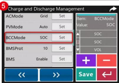
5. 点击 **>>** 切换到“Charge and Discharge Management（充放电管理）”界面，设置“BCCMode（策略选择）”为“VOL（电压）”或者“SOC”。设置完成后，点击 **Save** 下发新参数值。
