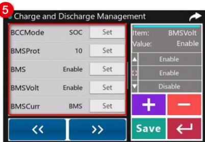
5. 点击 **>>** 切换到“Charge and Discharge Management (充放电管理)”界面，设置“BCCMode (策略选择)、BMSProt (BMS 协议号)、BMS (BMS 使能)、BMSVolt (BMS 电压控制)、BMSCurr (BMS 电流控制)”。设置完成后，点击 **Save** 下发新参数值。
