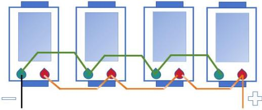
**警告:** 电池串联或并联时, 使用万用表测量电池电压, 必须满足各电池电压一致或压差小于 0.2V(并联接线时或有轻微的火花是正常现象), 超出此范围禁止对电池进行串/并联使用。
