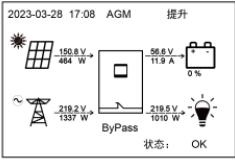
② 当 PV 的功率小于等于(允许充电电流 MCC\* 蓄电池电压)时, 市电给负载供电, 同时市电和 PV 一起给蓄电池充电。
