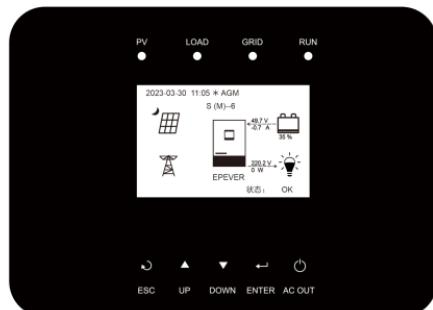
注意：水平视线和液晶屏的角度在 90° 范围内才可以清晰的看到液晶屏的显示内容。如果角度超过 90°，液晶屏的显示内容无法看清。
