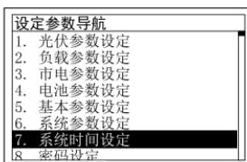
按照章节 2.4.3 管理员界面介绍，进入“设定参数导航”画面；按 UP/DOWN 键切换到“7. 系统时间设定”导航菜单，按 ENTER 键进入系统时间设置界面。在当前画面下，ENTER 作为右移键，AC OUT 作为左移键，UP/DOWN 键调整数值。全部数据设置完成后，将光标移到首位数字处，按 ENTER 键确认。软件自动执行设定动作，数据符合范围则执行更新操作。
