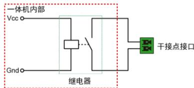
◆ **工作原理：**当蓄电池电压等于“干接点开启电压”时，继电器的线圈通电，开关闭合。干接点可驱动阻性负载125VAC/1A, 30VDC/1A。根据不同的电池类型，一体机的干接点开启电压和干接点停止电压默认值不同；详细默认值可参考“2.5.1 参数列表 > 5. 基本参数设定”的干接点开启电压和干接点停止电压。
