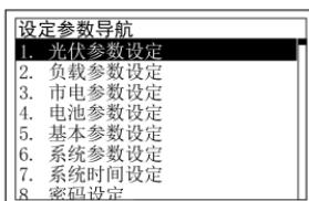
按照章节 2.4.3 管理员界面介绍，进入“设定参数导航”画面；按 UP/DOWN 键可对 1~9 项导航下的参数分别进行设定。各参数默认值及设置范围如下表格所示。
