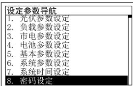
按照章节 [2.4.3 管理员界面](#)介绍，进入“设定参数导航”画面；按 UP/DOWN 键切换到“8. 密码设定”导航菜单，按 ENTER 键进入修改密码界面。在当前画面下，ENTER 作为右移键，AC OUT 作为左移键，UP/DOWN 键调整数值。全部数据设置完成后，将光标移到首位数字处，按 ENTER 键确认。
